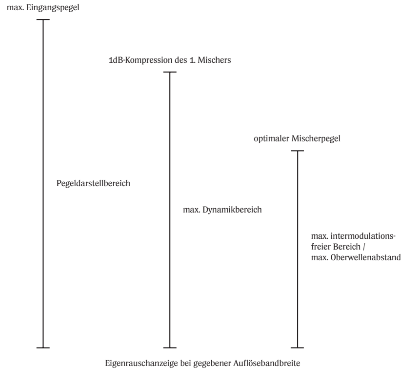
Bild 5-18 Vergleich von Pegeldarstellungsbereich, maximalem Dynamikbereich und maximalem intermodulationsfreien Bereich
