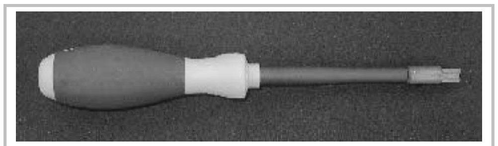
Handwerkzeug zur manuellen Verdrahtung des Schneidkontaktes der CW-Klemmen
