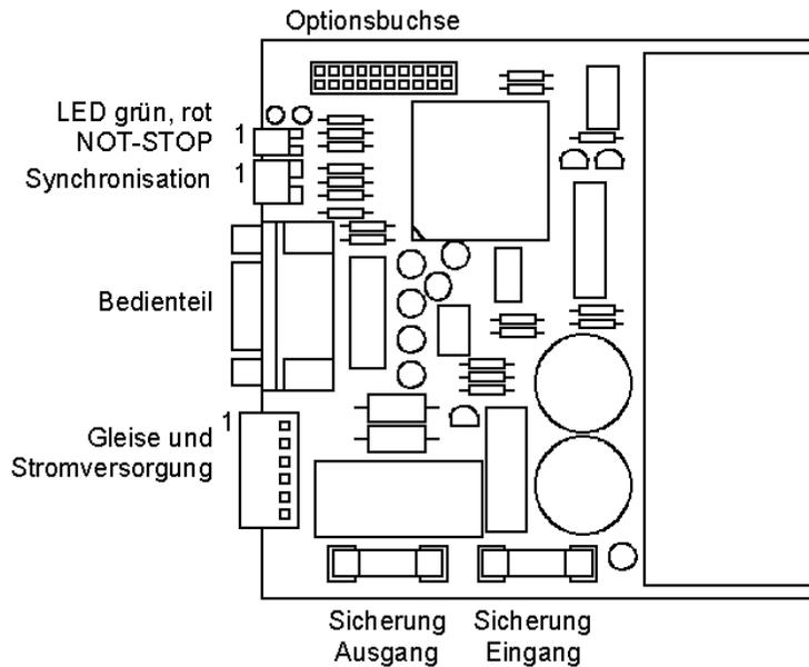
In der Zeichnung sind an den Steckverbindungen der jeweils erste Anschluss mit einer "1" gekennzeichnet. Die Steckverbindungen sind verdreh- und verwechslungssicher ausgeführt. Die Optionsbuchse ist für den Anschluss von Optionsplatinen vorgesehen.
