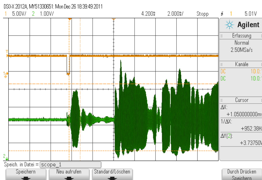
Bild 6: Ultraschallsignal mit Störreflexionen aus dem Nahfeld
