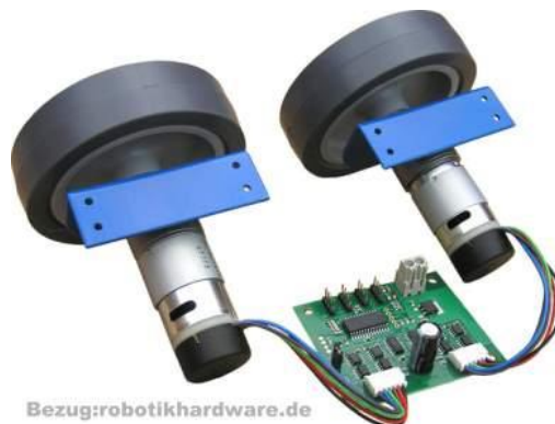
Das Bild zeigt das Board mit angeschlossenen EMG Motoren
