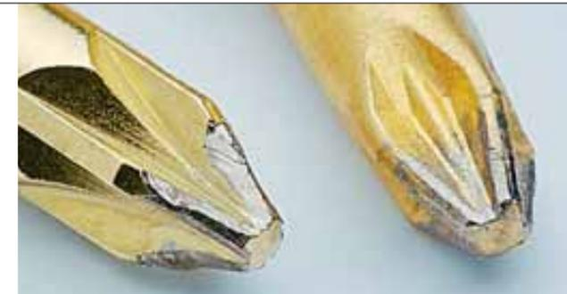
Billig-Bits zeigen schon nach wenigen Verschraubungen deutliche Abnutzung (links). Rechts ein guter Bit nach rund vierzig Verschraubungen
