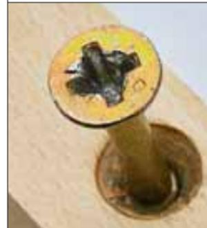
Trotz hoher Andruckkraft wird mit Billigbits der Schraubenkopf überdreht
