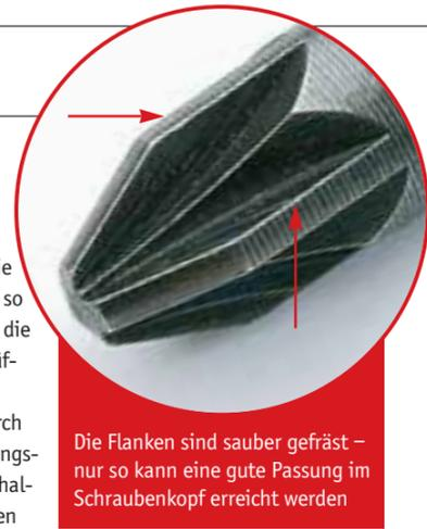
Die Flanken sind sauber gefräst – nur so kann eine gute Passung im Schraubenkopf erreicht werden
