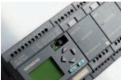
LOGO! im Zusammenbau mit den Funktionsmodulen
