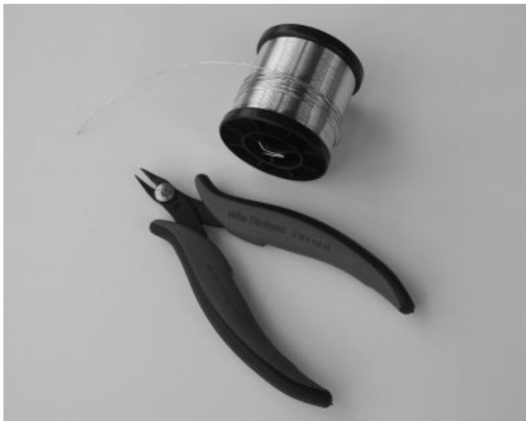
Abbildung 6-1 Seitenschneider und Elektroniklötzinn
