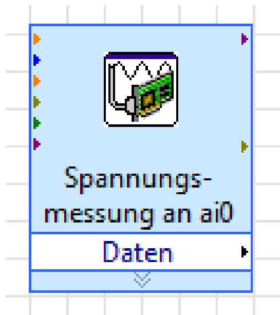
Abb.3.2.14: Passende Namen verbessern das Verständnis im Blockdiagramm
