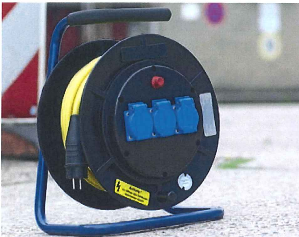
Abb. 11 Geeigneter Leitungsroller für den Einsatz auf Bau- und Montagestellen mit isoliertem Griff und Trommel aus Isolierstoff
