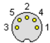
5 Pin Din Plug (pin view)
