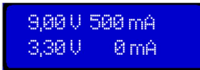
Wird das Poti zur Strombegrenzung betätigt, wird in der zweiten Zeile der aktuell eingestellte Wert angezeigt
