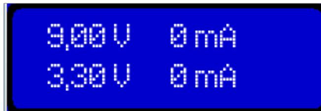
Wird ein Verbraucher angeschlossen, wird der aktuelle Strom angezeigt
