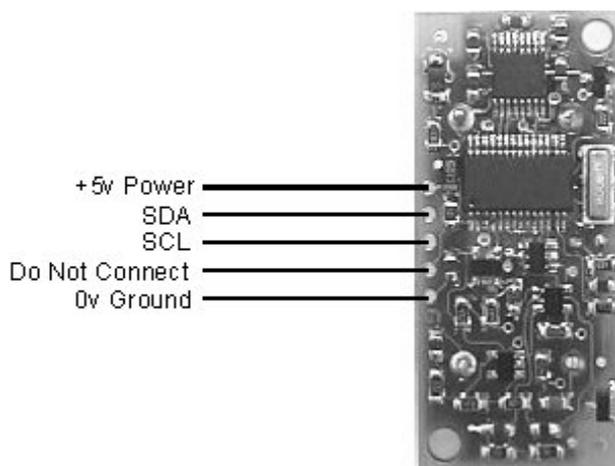
Der "Do Not Connect" Anschluss dient der werkseitigen Programmierung und sollte unbeschalten bleiben. Die SCL und SDA Leitungen werden einmal auf dem gesamten Bus durch Pull-Up Widerstände abgeschlossen (gewöhnlich am Bus-Master). Das SRF08 arbeitet ausschließlich im Slave-Mode. Normalerweise sind diese Widerstände im System bereits vorhanden.
