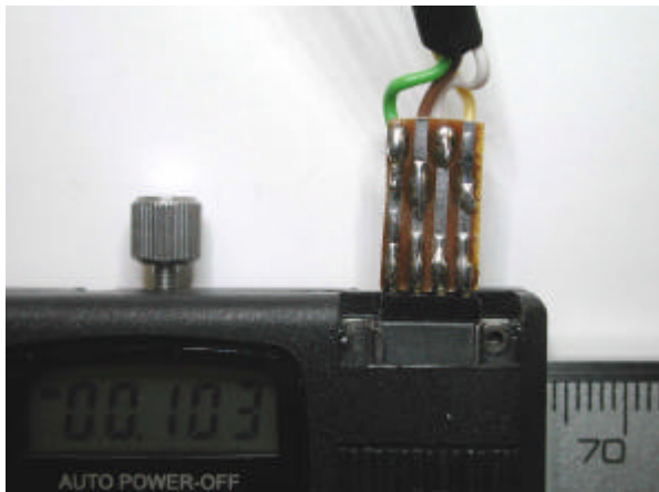
Bild 12 Schieblehre mit eingestecktem Kabel
