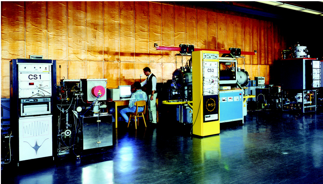
Bild 3: Ansicht der primären Uhren CS1 und CS2 der PTB
