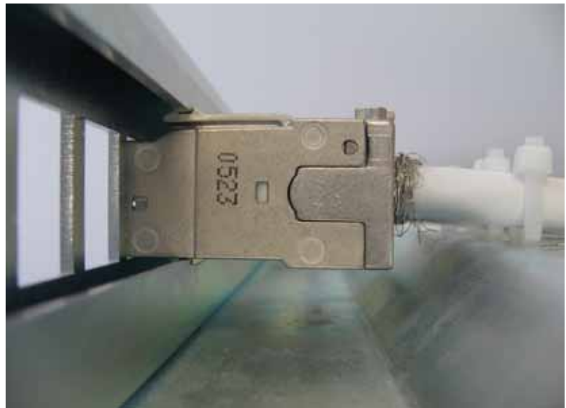
Bild 71: Schirmübergabe-Panel und angeschlossener geschirmter Jack
