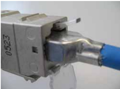
Bild 74 : Schirm-Übergang vom Stecker zum Jack
