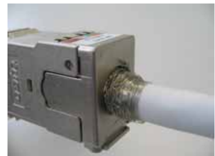
Bild 63: Angeschlossener geschirmter Jack
