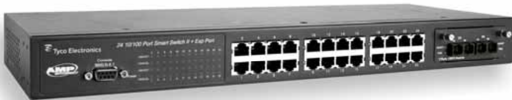
Bild 92: Switch mit geschirmten Buchsen
