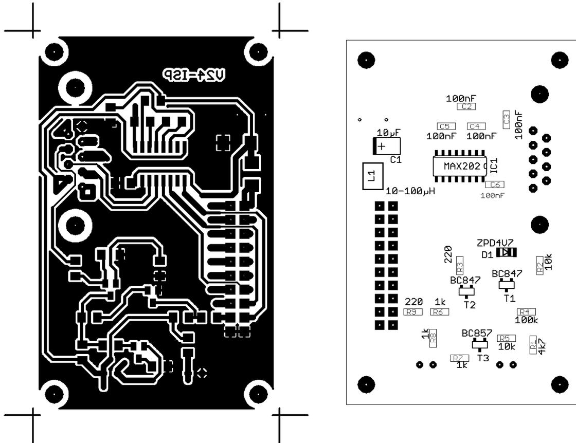
Die Größe des Originals zwischen den Kreuzungspunkten der Eckkreuze ist 44,5mm auf 70,0mm. Die beiden Punkte über Kondensator C1 gehören zu einer nicht eingezeichneten Brücke. Auf einer Platine muss die Brücke bestückt sein.
