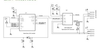
Das CAN-Interface besteht im Wesentlichen aus zwei Bauteilen, dem MCP2515 (CAN-Controller) und dem MCP2562 (CAN-Transceiver). Die Beschaltung ist wie im Datenblatt beschrieben. Zusätzlich ist ein Jumper verbaut, der es ermöglicht einen  $120\Omega$ -Abschlusswiderstand direkt auf dem Board zu nutzen.
