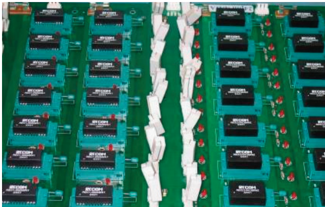
Abb. 7.2: DC/DC-Wandler während des Tests in einer Burn-in-Kammer ( T_{AMB} = 40^{\circ}\text{C} )
