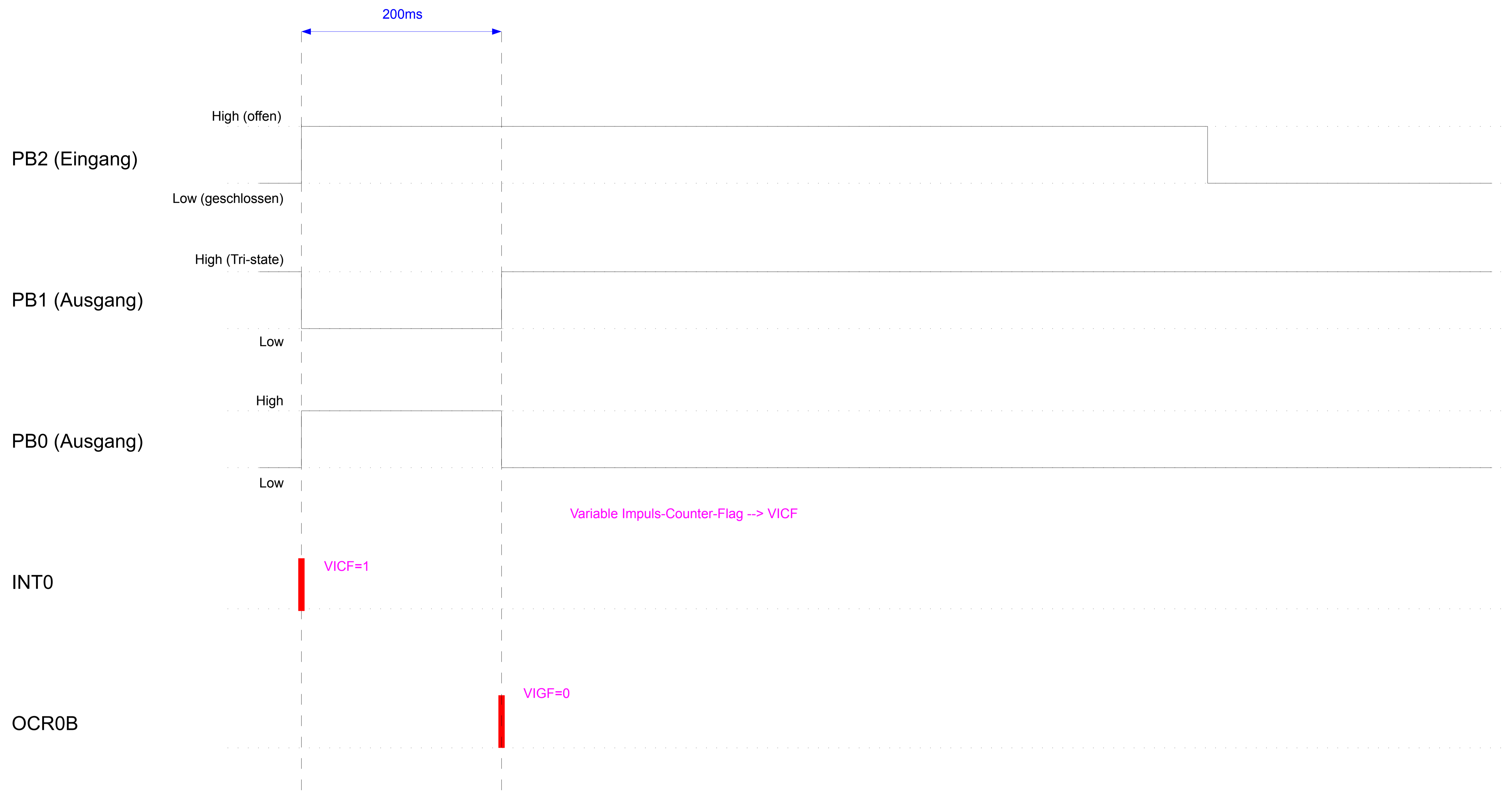
Timing-Diagramm bei Low/High-Flanke am Eingang PB2
