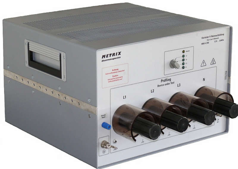
Netznachbildung (LISN) 0.15 bis 30 MHz für sehr hohe Ströme und Spannungen Typ NNB-4/350A (Hersteller: METRIX Electromagnetics)
