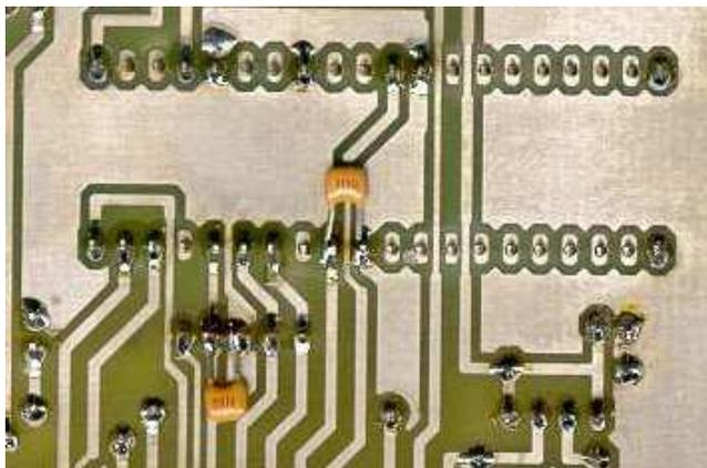
Abbildung 2 Leiterseite eines entsprechend Rev. 4 modifizierten Brenner8
