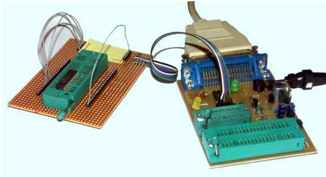
Abbildung 9 Universeller DIL-Programmieradapter (hier am Brenner5)
