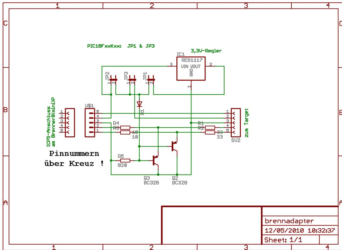
Abbildung 52 Stromlaufplan des Brennapters
