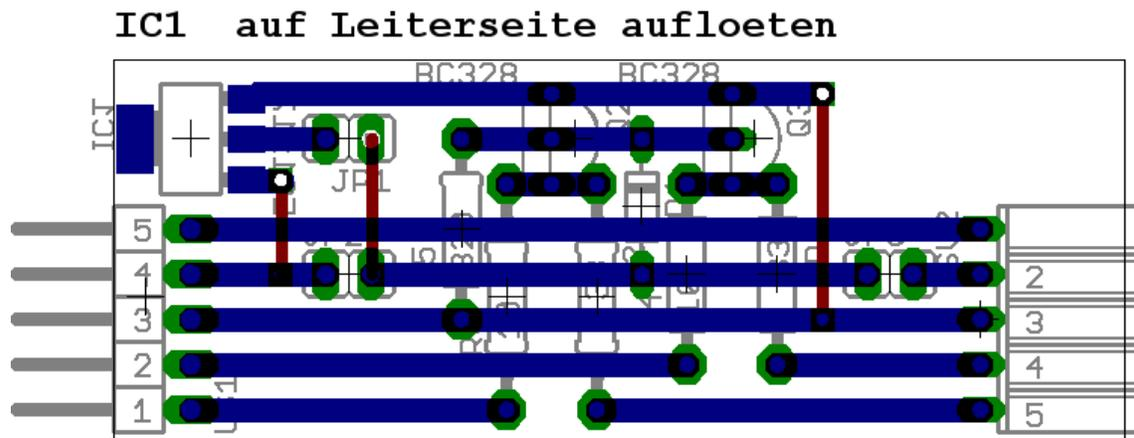
Abbildung 53 Layout des Brennapters für Streifenleiterplatte
