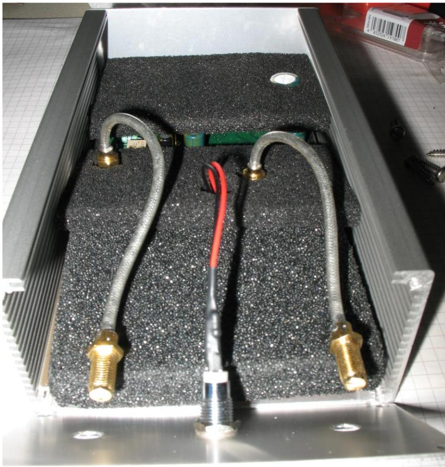
Bild4: Reduzierung „Welligkeit“ im Rauschfloor durch eingebrachte leitfähige Schaumstoffplatten aus einer IC-Versandbox
