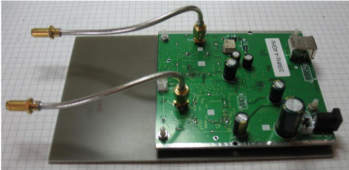
Bild1: Montage Platine isoliert auf einseitig Cu-kaschierter Europakarte. Anschlüsse RG402.
