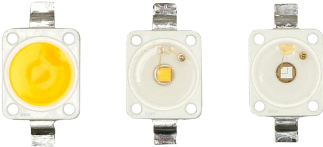
Bild A.28: Fotografische Aufnahmen verschiedener Typen der *Golden Dragon* von *Osram* zur Darstellung der Position des Leuchtstoffs nach Bild A.27.
