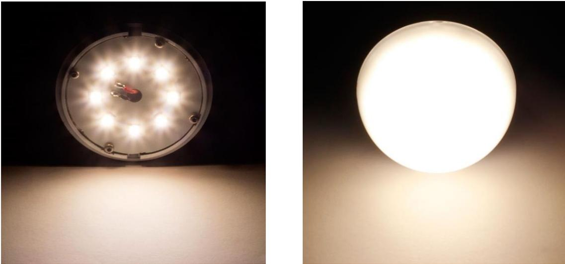
Bild A.4: Eindruck der Leuchtdichteverteilung einer LED-Retrofit-Lampe ohne Diffusor (links) und mit aufgesetztem Diffusor (rechts).
