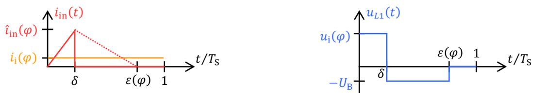
Bild 5.16: Prinzipieller dreiecksförmiger Verlauf (links) des Eingangsstroms  $i_{in}$  der Schaltzelle sowie die Spannung  $u_{L1}$  über der Spule (rechts) für eine Hochfrequenzperiode  $[0; T_S]$ . Der Mittelwert des Eingangsstroms  $i_{in}$  entspricht dem Netzstrom  $i_i$ . Der Spulenstrom ist gepunktet gezeichnet. Die dargestellten Verläufe gelten exemplarisch für eine Position  $0 < \varphi < \pi$  innerhalb der positiven Netzhalbschwingung mit  $u_i(\varphi) > 0$ .
