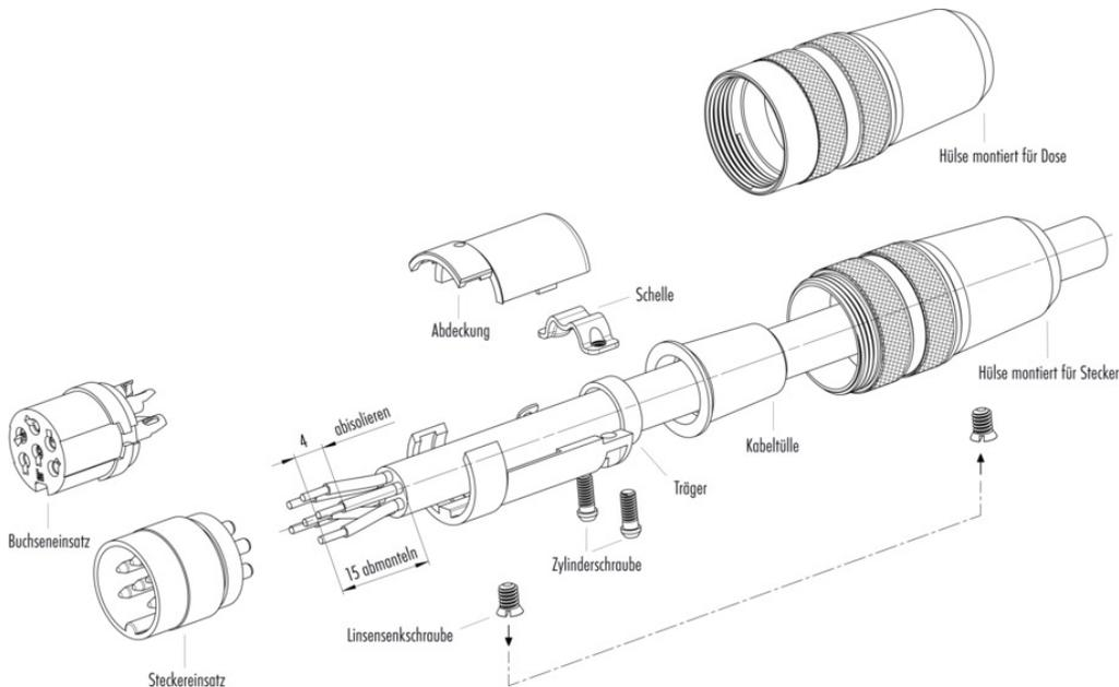
1. Kabelträger, Kabelhülle und Hülse auf Kabel fädeln.
