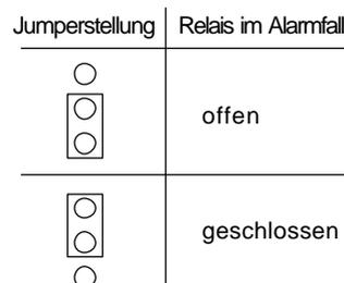
Hinweis: Der optionale Alarmausgang hat eine Schaltleistung von 40VDC/AC, 0.5A. Sollten Sie eine höhere Schaltleistung (z.B. 230V~) benötigen kann an dem Relaisausgang ein externes Schaltrelais (GNR10) angeschlossen werden, mit dem dann eine Schaltleistung von 250VAC/10A zur Verfügung steht.
