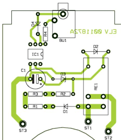
Ansicht der fertig bestückten Platine mit zugehörigem Bestückungsplan des 230-V-Schaltinterface.
