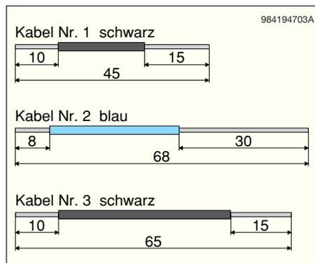
**Bild 2: Anzufertigende Kabelabschnitte**
