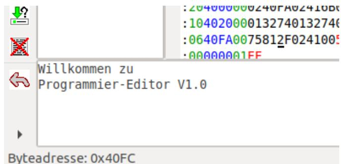
Die zusammengehörigen zwei Zeichen des Datenbyte beim Cursor sind durch einen roten Unterstrich markiert. Befindet sich der Cursor auf der Anzahl der Recordbyte, wird diese dezimal in der Statuszeile angezeigt.
