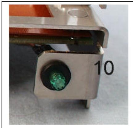
Ist die Stromversorgung ordnungsgemäß angeschlossen und eingeschaltet, muss die LED leuchten.
