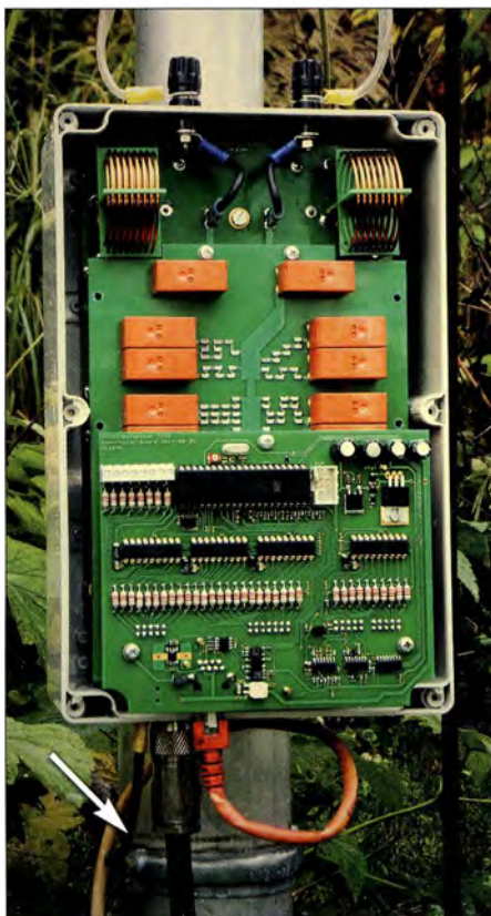
Bild 15: Installation des Kopplers in Bodennähe am metallischen Mittelmast der Antenne (Gehäusedeckel abgenommen); links unten ist die kurze Erdverbindung zum Mastrohr zu erkennen (Pfeil).
