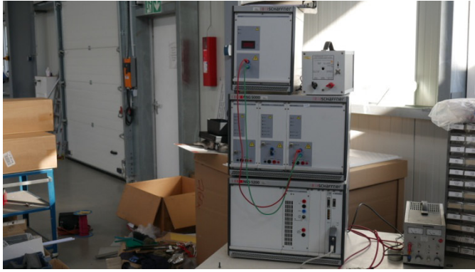
KFZ-Impuls-Messplatz Schaffner NSG 5xxx, Pulse 1-4, 5a, 5b nicht voll funktionsfähig
