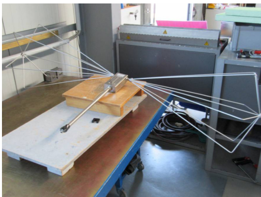
Antenne Schwarzbeck VHBD 9134 20-200MHz
