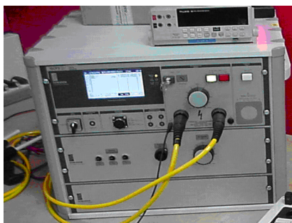
Kombitester GLP2i Schleich Kompl Prüfplatz SEB siehe Prüfplatzbeschreibung
