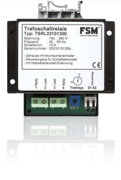
Das TSRL ist ein elektronisches Relais zum Schalten von Transformatoren. Es schaltet einen oder mehrere Einphasentransformatoren im Leerlauf oder unter Last ohne Einschaltstromstoß (Inrush) ein. Durch dieses Sanft-Einschalt-Verfahren wird der Einschaltstromstoß vermieden und nicht nur begrenzt. Auftretende Kurzschlussströme werden durch das TSRL nicht begrenzt.
