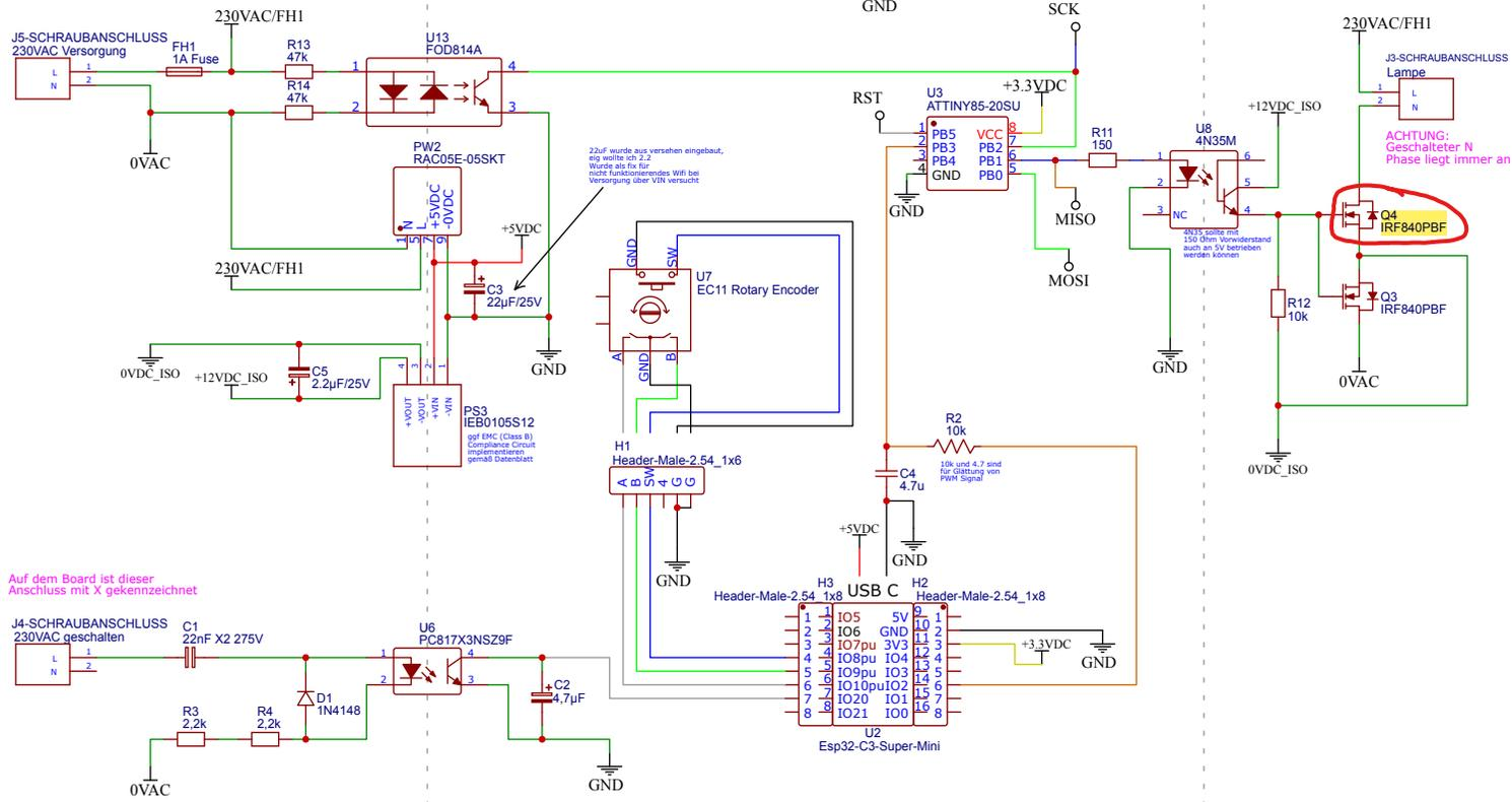
22µF wurde aus versehen eingebaut, eig wollte ich 2.2. Würde als fix für nicht funktionierendes Wifi bei Versorgung über VIN versucht
