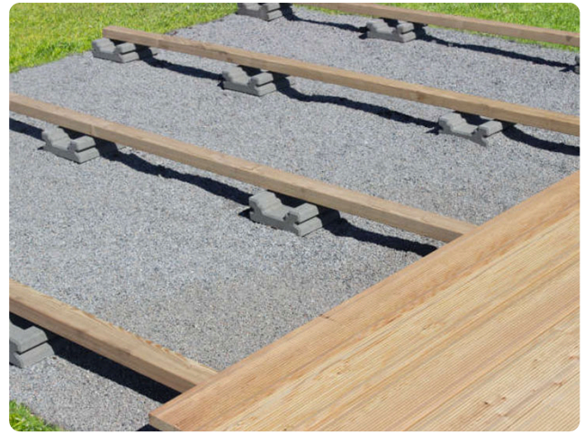
Der DIEPHAUS Fundamentstein: gleicht Höhenunterschiede aus, verleiht Stabilität und schützt Holzkonstruktionen vor Nässe. (Fotos: Diephaus Betonwerk)
