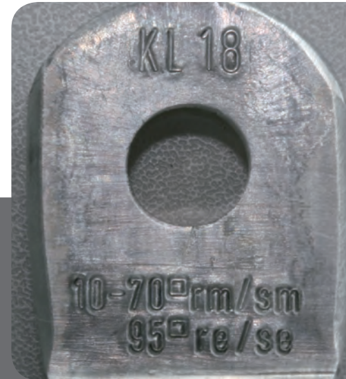
Markierungen auf den Kabelschuhen geben wichtige Hinweise zu Herstellerkennziffer, Anschlussbohrung, Querschnitt und Kabelzuordnung
