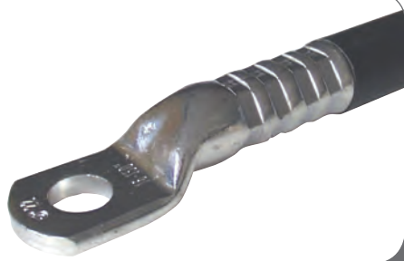
Werkzeugkennziffer auf dem Kabelschuh und eingeprägte Kennziffer weisen auf die korrekte Verpressung hin
