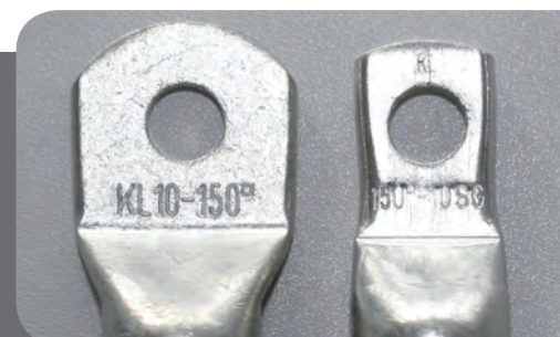
Der direkte Vergleich macht die unterschiedliche Bauform deutlich: links Standard-Rohrkabelschuh, rechts Rohrkabelschuh für Schaltgeräteanschlüsse mit schmalem Anschraubflansch
