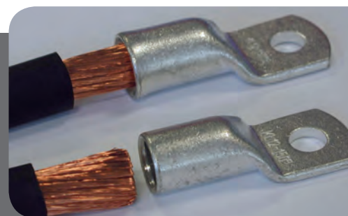
Rohrkabelschuhe Baureihe F (oben) für feindrähtige Leiter ermöglichen das leichte Einführen des Leiters ohne das Aufspleißen der Leiterdrähte
