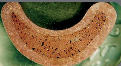
Das Schliffbild einer Dornpressung mit einem vom Hersteller empfohlenen Werkzeug zeigt die gleichmäßige Verteilung der Leiter im Kabelschuh
