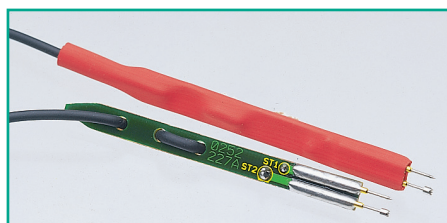
Bild 5: Spezial-Messleitungen mit federnd gelagerten Mess-Spitzen
