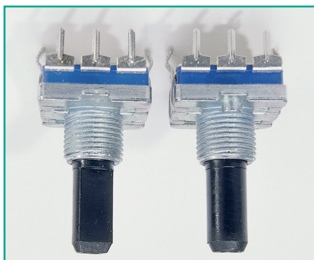
Bild 73: Die Führungsnase des Inkrementalgebers (rechts) wird abgeschnitten (links).
