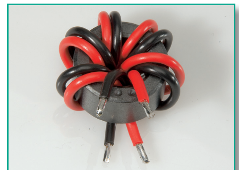
Bild 71: Durch den Ferritkern gefädelt Leitungsabschnitte
