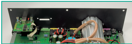
Bild 87: Montierte Rückwand am Gehäuseunterteil mit USB-Modul
