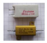
mehr als die geforderte Leistung aufweisen. Aber **Vorsicht**, der 33 Ohm Widerstand setzt fast 8Watt in Wärme um und wird mit der Zeit entsprechend heiß.
